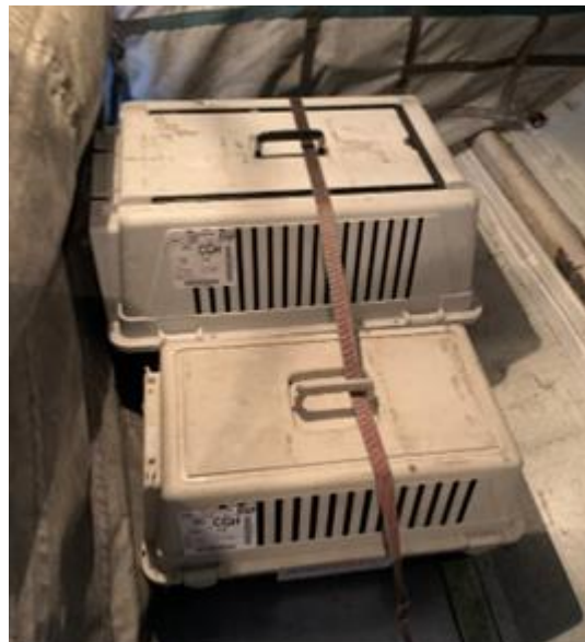
Figura 59 - Amarração da caixa de transporte de AVIH
