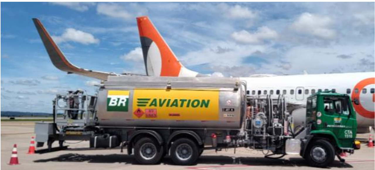
Figura 16 - Caminhão abastecedor (tanque)
