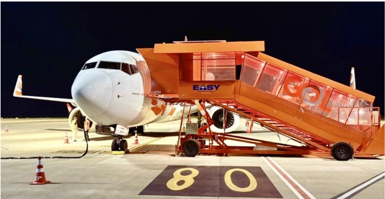
Figura 34 - Escada com Elevador
