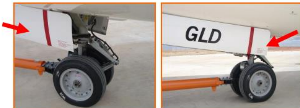
Figura 63 - Atenção nas operações de Pushback/Pull forward
