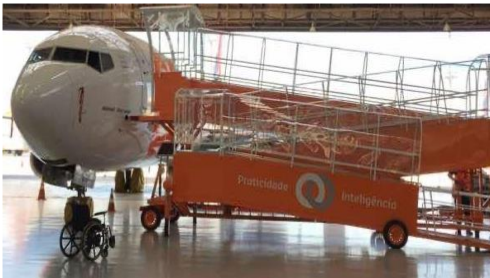
Figura 31 - Rampa de acesso
