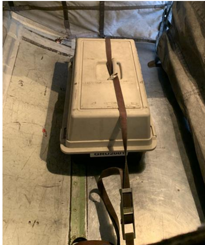
Figura 58 - Amarração da caixa de transporte de AVIH
